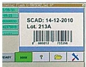
Il display grafico a colori interattivo (touch screen) semplifica l'operazione di modifica locale dei dati (Data di scadenza, Lotto, etc.) e permette il controllo "on-line" di quello che la macchina stampa. Il testo dell'etichetta è visualizzato sullo schermo e può essere anche ingrandito (zoom). La memoria interna FLASH di grande capacità permette di conservare una grande quantità di testi di etichette
